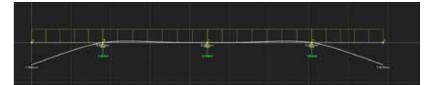
Şekil 2. Levhalarda oluşan deformasyon
